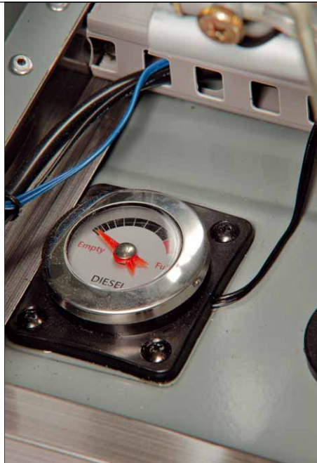
Auch die Füllstandsanzeige für den Tank ist gut zugänglich und leicht abzulesen
