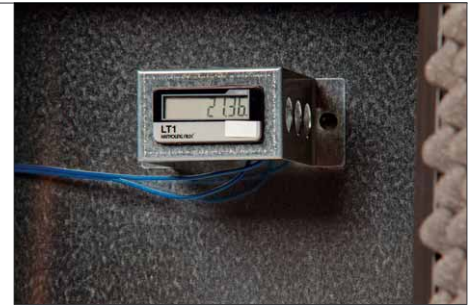
Der Stundenzähler ermöglicht eine gute Abschätzung wieviel Energie verbraucht wurde
