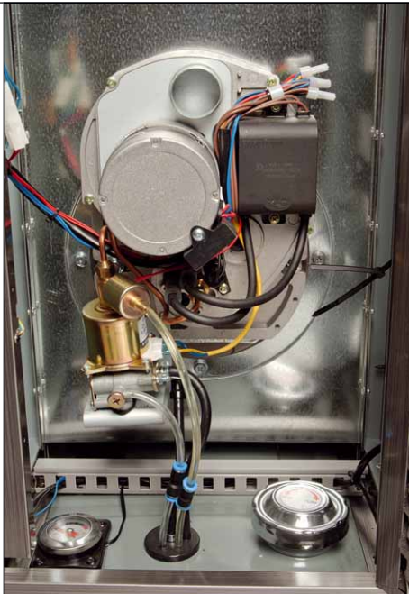
Rechts im Bild ist der Einfüllstutzen für den Kraftstoff gut zu erkennen
